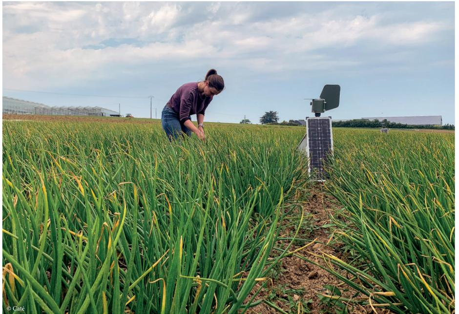
Des capteurs de spores de mildiou ont été utilisés pour optimiser le positionnement des premiers traitements.
